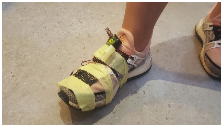
BBC micro:bit krokomer pripevnený páskou o topánku
